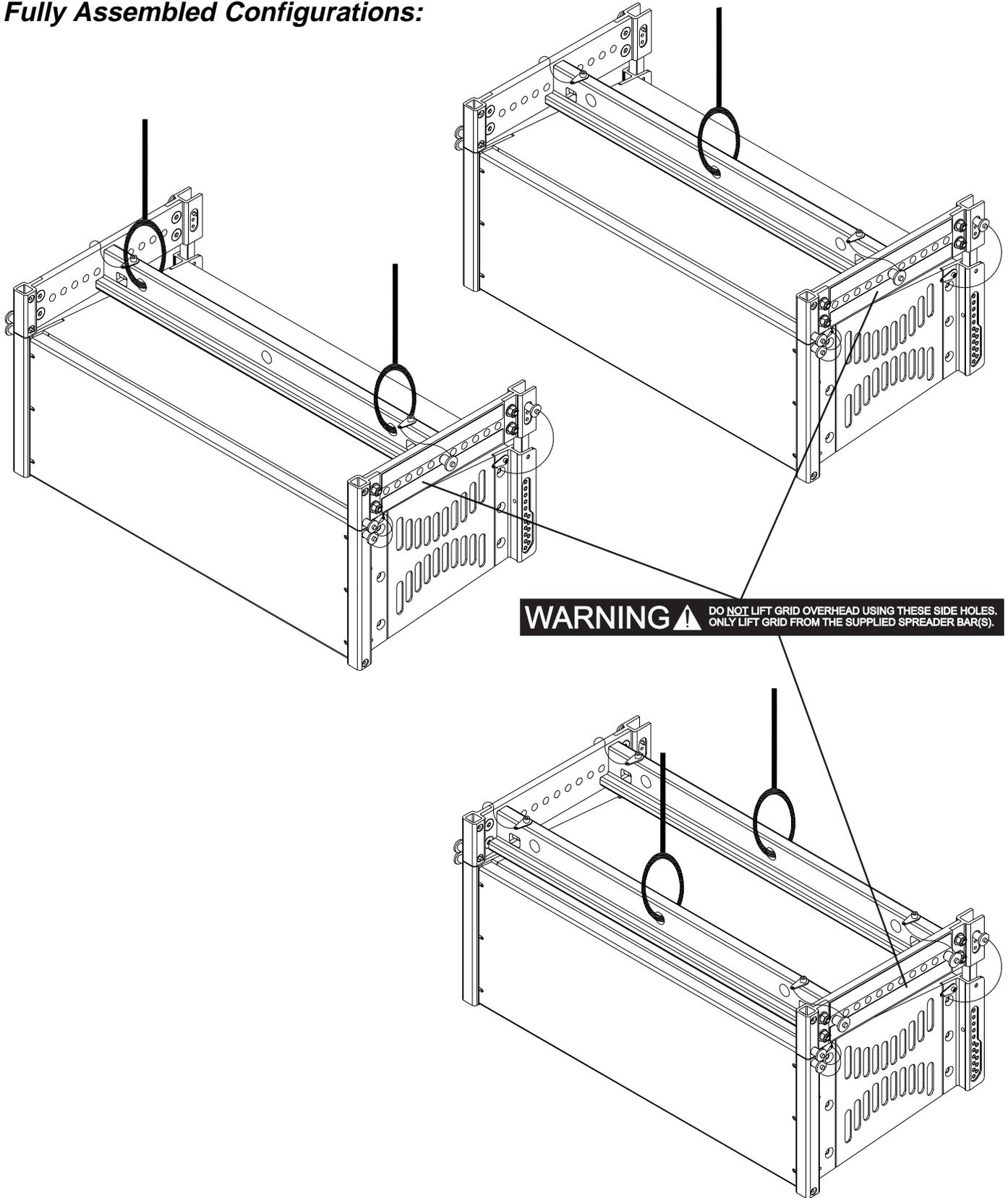
**WARNING!** DO NOT LIFT GRID OVERHEAD USING THESE SIDE HOLES. ONLY LIFT GRID FROM THE SUPPLIED SPREADER BAR(S).
