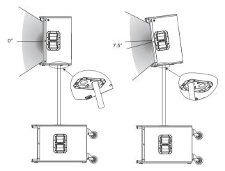
図 4.1: 最適カバレッジのマルチアングルポールカップ 0°(左) およびマルチアングルポールカップ 7.5°(右)
