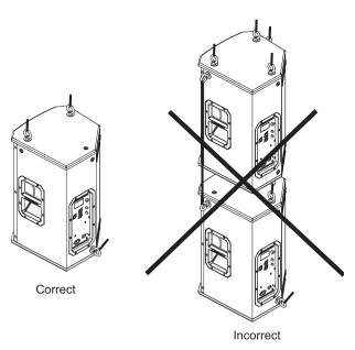
図 4.11: スピーカーの垂直吊り下げ
