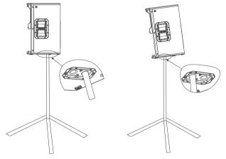
図 4.3: マルチアングルポールカップ 0°(左) およびマルチアングルポールカップ 7.5°(右)
