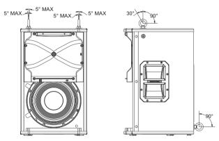
図 4.10: 最大使用荷重-垂直の向き
