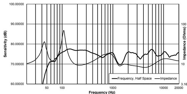
Risposta in frequenza e impedenza 1 watt / 4 metri / sull'asse (con equalizzazione richiesta EN54)
