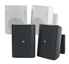
O EVID-S5.2T utiliza um transformador de 30 W que oferece uma seleção de 3,7 W (somente para 70 V), 7,5 W, 15 W ou 30 W fornecidos ao sistema de altofalantes por meio de linhas de 70 V ou 100 V, ou um bypass de 8  $\Omega$  para linhas de baixa resistência. A seleção é feita por meio de um interruptor conveniente no painel de entrada, localizado na parte traseira do alto-falante.
