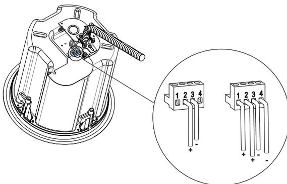
Figura 4.5: cablaggio, condotto flessibile
