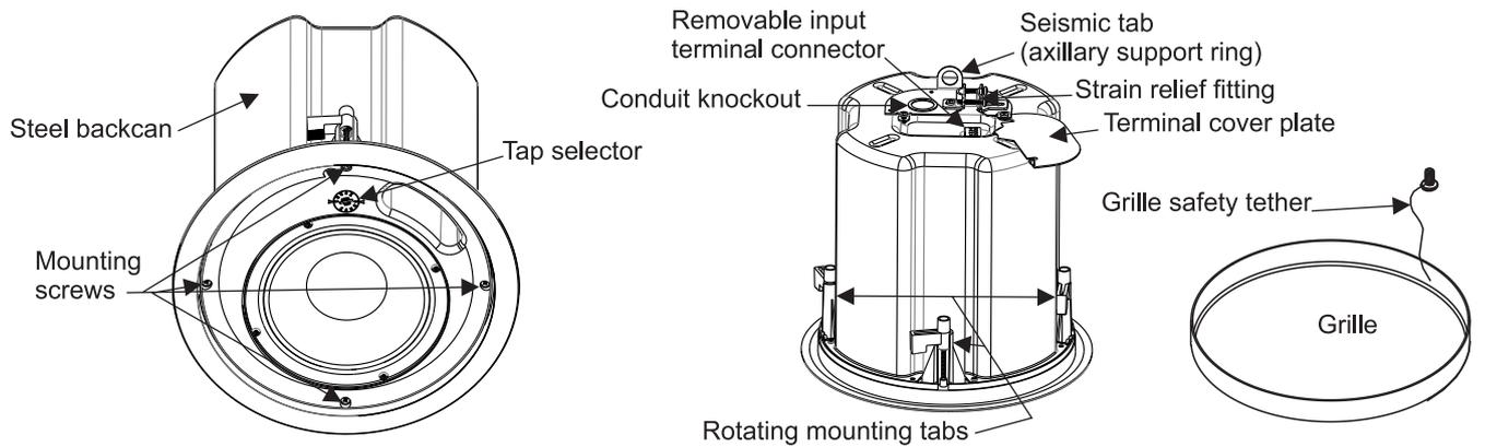
Figura 3.2: Parte superiore e inferiore dell'altoparlante a soffitto
