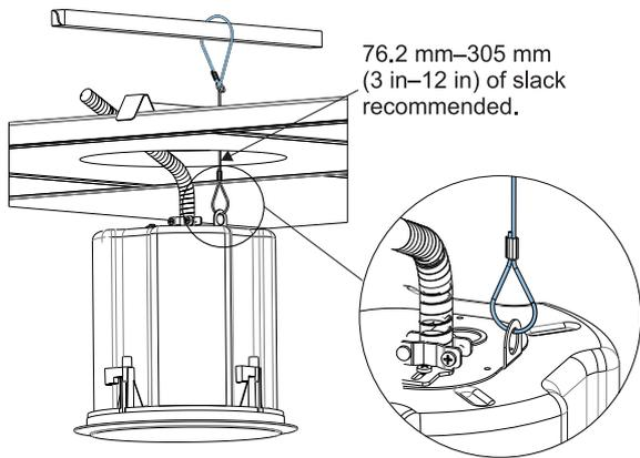
Figura 4.7: fissare il cavetto di supporto ausiliario
