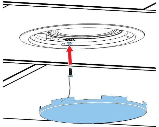
**Figura 4.12: inserire il punto di attacco griglia**
