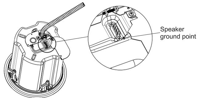
Figura 4.4: cablaggio, punto di messa a terra
