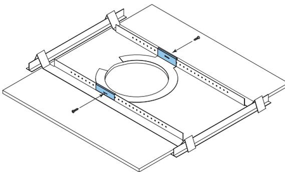
Figure 4.3: fissare i binari all'anello a C
