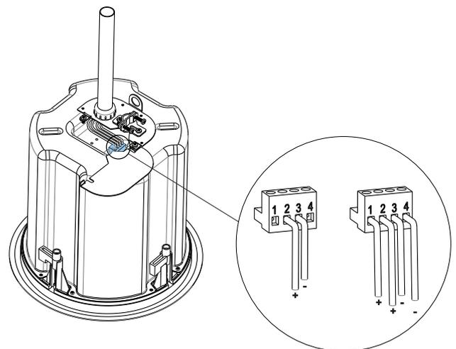
Figura 4.6: cablaggio, condotto rigido
