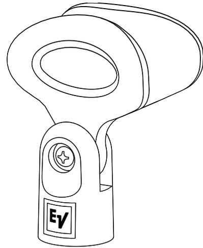
El RE3-ACC-HHTSA1 de Electro-Voice es un adaptador de soporte de micrófono resistente para transmisores portátiles RE3 HHT. El adaptador de soporte se enrosca en soportes de micrófono estándar de 5/8 x 27 y en soportes de tipo europeo de 3/8 x 16 cuando se utiliza con el adaptador de rosca incluido. El material rígido de TPE sujeta el transmisor de forma segura, a la vez que ese mismo material es lo suficientemente flexible como para facilitar la inserción y la retirada del transmisor.
