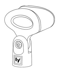
L'Electro-Voice RE3-ACC-HHTSA1 est un adaptateur robuste pour pied de microphone destiné aux émetteurs à main RE3-HHT. L'adaptateur pour pied se visse sur des pieds pour microphone 5/8 x 27 standard, ainsi que sur des pieds de 3/8 x 16 de style européen en cas d'utilisation avec l'adaptateur de filetage inclus.
