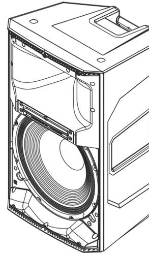
ELX200-15P dispone de amplificadores de clase D de alta eficiencia (hasta 1200 W) con Quick**Smart**DSP integrado y proporciona hasta 132 dB de SPL mediante transductores diseñados y fabricados por EV (woofer EVS-15M de 15 pulgadas acoplado a un motor de compresión de titanio de 1 pulgada DH-1L). Los modelos autoamplificados de rango completo permiten hacer una configuración fácil con cuatro ajustes
