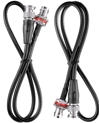
CXUF 是一对高品质、低损的同轴电缆，旨在将无线接收器的天线输入插孔重新定位到 19 英寸机架的前面板上。螺纹法兰底座连接器牢固地安装在 RMK1 或 RMK2 机架安装套件的开口中，用于正面安装车辆  $\frac{1}{2}$  波天线或延长同轴电缆。另一端的 BNC 公头扭接式连接器牢固地连接到接收器的天线 A 和天线 B 射频输入插孔。
