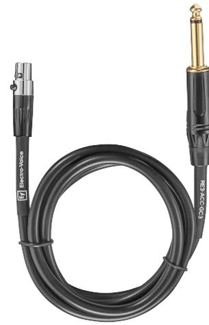
El CG3 es un cable especial para conectar instrumentos o fuentes de señal de nivel de línea con conectores de salida de 1/4" al transmisor de petaca RE3-BPT. El cable es robusto y tiene un enchufe de fácil sujeción de 1/4" en un extremo y un conector mini de 4 patillas estándar del sector en el otro. Conecta instrumentos de cuerda con bobinas pasivas o activas al transmisor para poder utilizarlos sin cables. Conecta fuentes de señal de nivel de línea al transmisor para utilizarlas sin cables.
