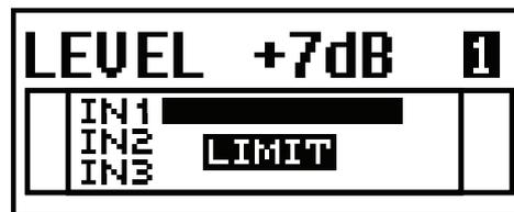
Die LIMIT-Anzeige wird angezeigt, wenn die Verstärkung des Signals verringert wird (Gain reduction). Auf diese Weise kann der Lautsprecher weiter betrieben werden, während verhindert wird, dass der Verstärker und die Komponenten ihre Funktionsfähigkeit nicht überschreiten. Pegel, die kontinuierlich über dem Limiter-Grenzwert liegen, müssen vermieden werden.
