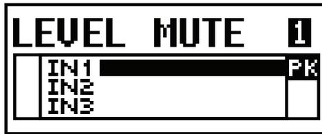
Wenn PK (Peak) angezeigt wird, ist die Magnitude des Eingangssignals höher als das, was der Verstärker verarbeiten kann. Sie wird effektiv abgeschnitten (verzerrt). Verringern Sie die Lautstärke der Signalquelle, und/oder verringern Sie den Eingangspegel, indem Sie den entsprechenden INPUT LEVEL-Knopf gegen den Uhrzeigersinn drehen. Der PK-Status muss zu jeder Zeit vermieden werden. Selbst kurzzeitige Bursts des abgeschnittenen Signals können die Systemkomponenten stark beschädigen.
