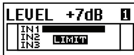
La indicación LIMIT se muestra cuando se aplica una reducción de ganancia a la señal. Esto permite que el altavoz siga funcionando a la vez que evita que el amplificador y los componentes excedan su capacidad funcional. Deben evitarse los niveles de funcionamiento continuo más allá del umbral del limitador.
