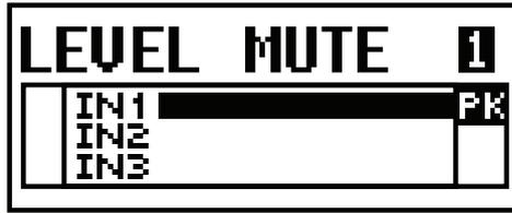
Cuando se indica PK (pico), la magnitud de la señal de entrada es superior a la que puede gestionar el amplificador y se recorta de forma efectiva (se distorsiona). Baje el volumen de la fuente de señal y/o baje el nivel de entrada girando el mando de nivel de entrada (INPUT LEVEL) correspondiente en el sentido contrario a las agujas del reloj. El estado de PK debe evitarse en todo momento. Incluso las ráfagas momentáneas de la señal recortada pueden dañar gravemente los componentes del sistema.
