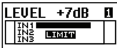
L'indication LIMIT est affichée lorsque la réduction du gain est appliquée au signal. Cela permet au haut-parleur de continuer à fonctionner tout en empêchant l'amplificateur et les composants de dépasser leur capacité de fonctionnement. Il est nécessaire d'éviter des niveaux fonctionnant continuellement au-delà du seuil limiteur.
