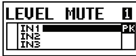
Lorsque PK (crête) est indiqué, l'amplitude du signal d'entrée INPUT est supérieure à ce que l'amplificateur peut gérer et elle est découpée (déformée). Réduisez le volume de la source du signal et/ou réduisez le niveau INPUT LEVEL en faisant pivoter le bouton d'entrée correspondant dans le sens contraire des aiguilles d'une montre. L'état PK doit être évité en permanence. Même des salves momentanées du signal écrêté peuvent endommager gravement les composants du système.
