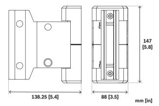
Fig. 1: Soporte montaje pared
