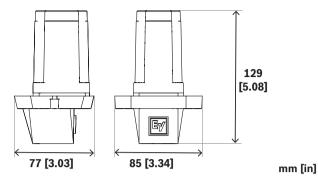
Fig. 2: Adaptador de altavoz de columna para EVOLVE-WMK con conector NL4
