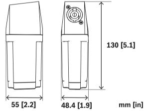
Fig. 3: Adaptador de subwoofer para EVOLVE-WMK con conector NL4
