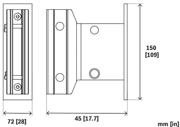
图片 1: 桁架安装支架
