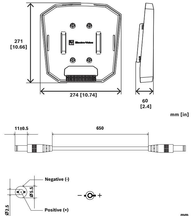
Abb. 1: EVERSE8 Gleichstromkabelmessung und Polarität
