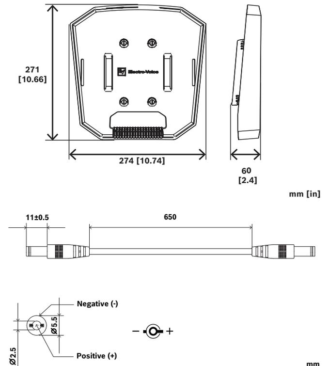
Fig. 1: Medidas y polaridad del cable de alimentación de CC EVERSE8
