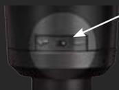
Con el selector en esta posición, la respuesta en frecuencia del micrófono está optimizada para voz e instrumentos, tanto acústicos como amplificados.
