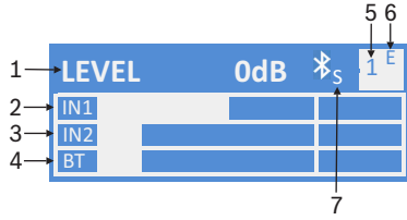
图片 4.2: 显示有蓝牙状态的常规系统状态主屏幕
