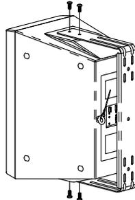
2. 将**10毫米额定锻造式羊眼螺栓**（不随附）安装到安全点。
