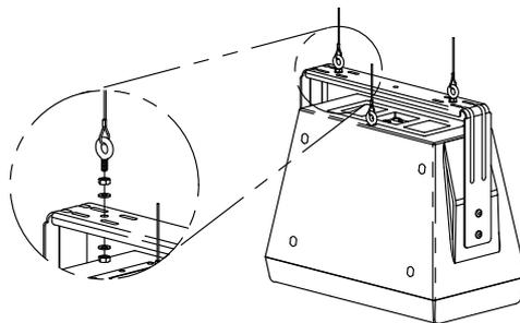
2. 将**10毫米额定锻造式羊眼螺栓**（不随附）安装到安全点。
