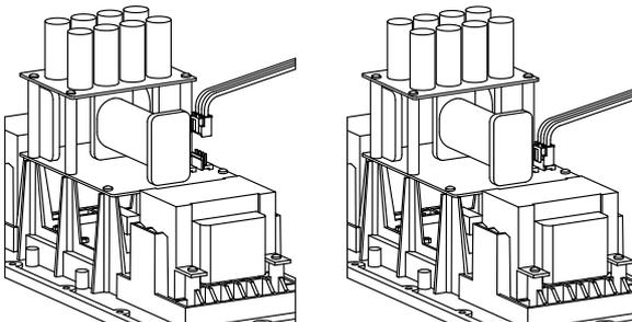
4. 安装变压器输入面板。
