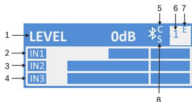
**Figura 5.1:** Pantalla principal de estado normal del sistema con el estado de Bluetooth®
