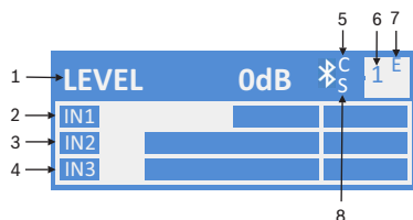
図 5.1: Bluetooth® ステータスを表示する、正常なシステム状態のホーム画面
