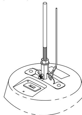
9. Fije el **cable de soporte auxiliar secundario** (no incluido) a un punto de soporte distinto del techo de la estructura del edificio.
