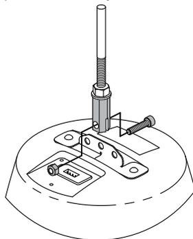
7. Apriete la **tuercas de bloqueo de nylon** en el otro extremo del tornillo de suspensión.
