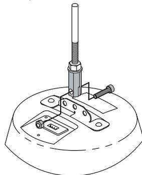
7. Serrez l'**écrou de blocage en nylon** à l'autre extrémité de la vis de suspension.
