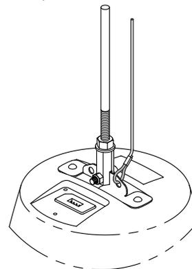
9. Fixez le **câble de support auxiliaire secondaire** (non inclus) sur un autre point de support du plafond de la structure du bâtiment.
