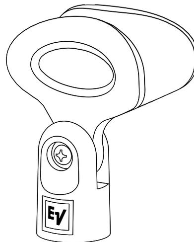
Electro-Voice RE3-ACC-HHTSA1 是一款适用于 RE3-HHT 手持式发射器的坚固的话筒支架适配器。这款支架适配器与附带的螺纹适配器结合使用可拧到标准的 5/8 x 27 话筒支架上，以及欧式 3/8 x 16 支架上。坚固的 TPE 材料稳固地支撑住发射器，同时这种材料也具有足够的弹性，让插入和取下发射器都很轻松。
