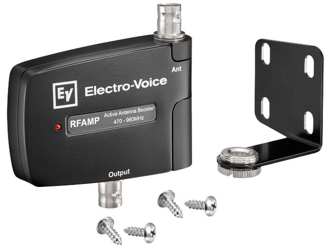
RFAMP ist ein HF-Verstärkermodul mit 10 dB, das als HF-Verstärker an der Antenne fungiert. Es kompensiert den Signalverlust vor einer Koaxialverbindung und dient als effektive Methode für eine abgesetzte Montage der RE3-RX ½-Wellen-Empfängerantenne, falls erforderlich. RFAMP erfordert 12 V DC Leistungsverstärker-Strom, der an den Antennenbuchsen des RE3-RX-Empfängers oder des aktiven AASP-Antennensplitters zugeführt wird.
