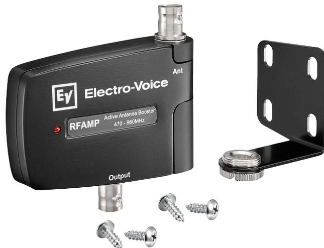
RFAMP es un módulo de amplificador de RF de 10 dB diseñado para funcionar como amplificador de antena RF a fin de compensar las pérdidas de señal antes de un tendido de cable coaxial y como medio eficaz de montaje remoto de la antena receptora de media onda estándar RE3-RX, si se desea. RFAMP requiere alimentación de 12 V CC que se suministra en los conectores de antena del receptor RX-RE3 o del divisor de antena activo AASP.
