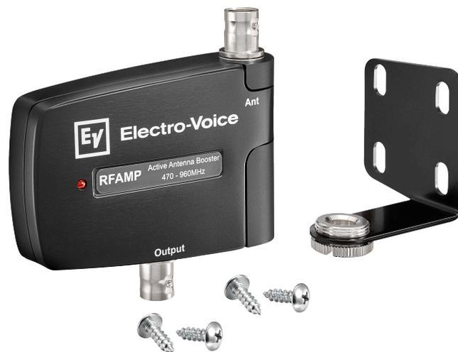
O RFAMP é um módulo amplificador de RF de 10 dB projetado para funcionar como um amplificador de RF na antena para compensar a perda de sinal antes da operação coaxial, bem como um meio eficaz de montagem remota da antena do receptor de ½ onda de estoque RE3-RX quando desejado. O RFAMP requer alimentação de amplificador de 12 VCC, fornecida nos conectores de antena do receptor RE3-RX ou do divisor de antena ativa AASP.
