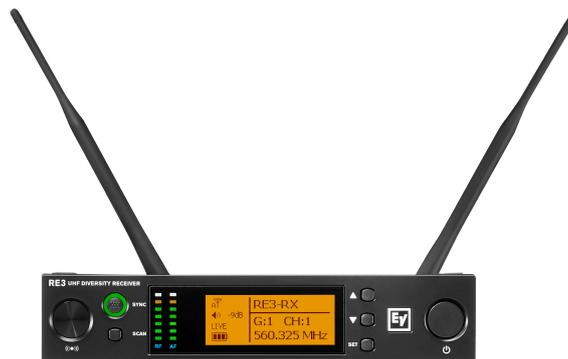
Le RE3-RX est un récepteur « diversity » de qualité professionnelle au format ½ rack 19". Conçu pour fonctionner en tant que centre de contrôle pour un ensemble RE3 sans fil, il offre les fonctions de recherche de fréquences et de synchronisation, ainsi que la transmission des réglages d'émetteur vers celui qui est synchronisé.
