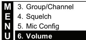
Das Display zeigt die aktuelle Lautstärkeeinstellung in dB-Dämpfung an, wobei 0 dB die höchste Ausgangslautstärke und -50 dB die niedrigste Ausgangslautstärke vor der Stummschaltung ist.
