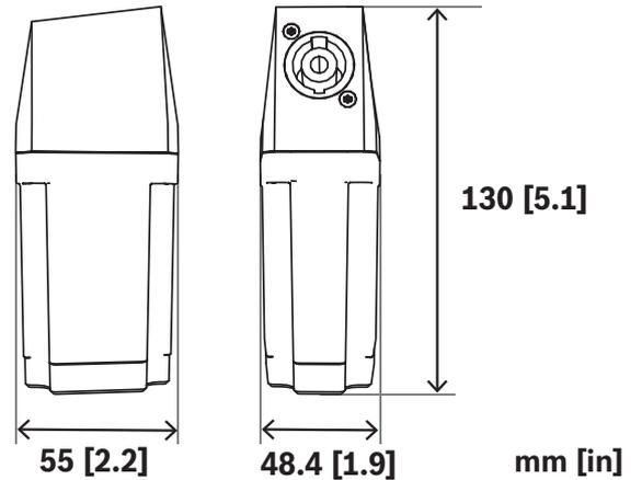
Fig. 3: Adaptador de subwoofer para EVOLVE-WMK con conector NL4
