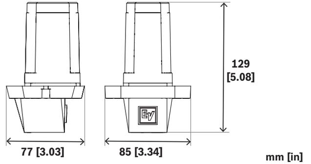
Fig. 2: Adaptador de altavoz de columna para EVOLVE-WMK con conector NL4
