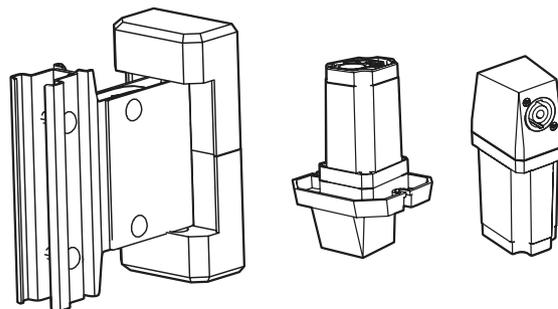
EVOLVE-WMKは、EVOLVE 30M、EVOLVE 50、EVOLVE 50M コラムスピーカーをサブウーファーから離して、ディスタンスポールなしで吊るすために使用されます。
