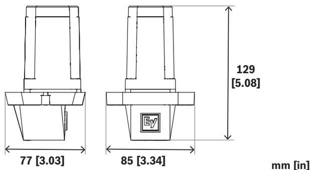
图片 2: 用于带有NL4连接器的EVOLVE-WMK的音柱扬声器适配器
