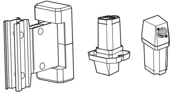
EVOLVE-WMK可以无需距离标杆, 将EVOLVE 30M、EVOLVE 50和EVOLVE 50M音柱扬声器吊挂在远离低频扬声器的位置。
