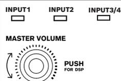
5. Conecte uma fonte de áudio usando um cabo XLR, TRS ou TS a **INPUT 1 (Entrada 1)**, **INPUT 2 (Entrada 2)** ou um miniconector de 3,5 mm a **INPUT 3/4 (Entrada 3/4)**. Garanta que a fonte de áudio esteja em **MUTE (Mudo)** ou em um nível baixo antes de fazer conexão. Depois de fazer a conexão, aumente a saída da fonte para um nível razoável.
