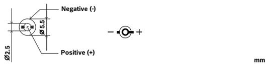
図 2: EVERSE8 DC 電源ケーブルの測定と極性
