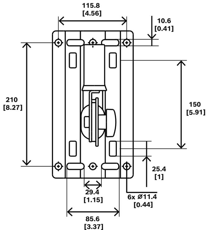
Abb. 3: Abmessungen des Schlitzes der Halterung
