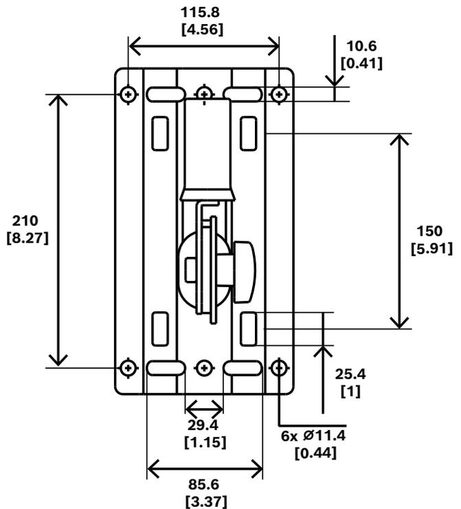
Fig. 3: Dimensions de la cannelure du support
