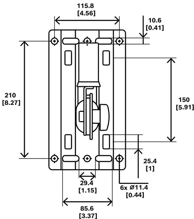
図. 3: ブラケットのスロットの寸法
