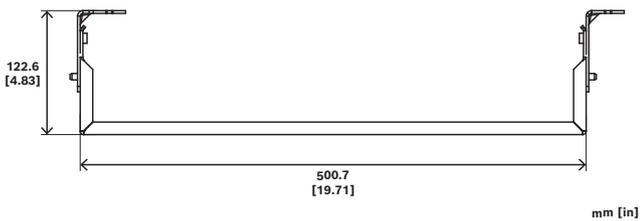
Fig. 3: Montage sur support en U
