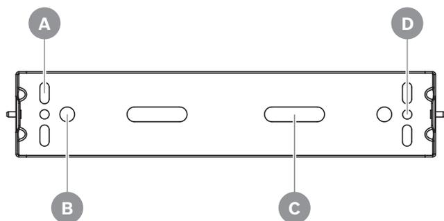
**A** Pour un montage vertical ou horizontal à l'aide de quatre vis OU montage mât/structure pour taille de tube nominale de 2" (DN50) à l'aide de deux boulons en U. Accepte les diamètres de fixation jusqu'à 3/8" ou M10.
