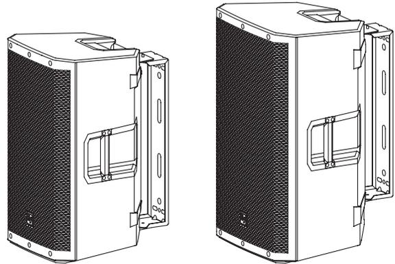
O ZLX-G2-BRKT é usado para montar uma caixa de som full-range ZLX-12-G2, ZLX-12P-G2, ZLX-15-G2 ou ZLX-15P-G2 na parede, no teto, em uma haste, cano ou treliça.
