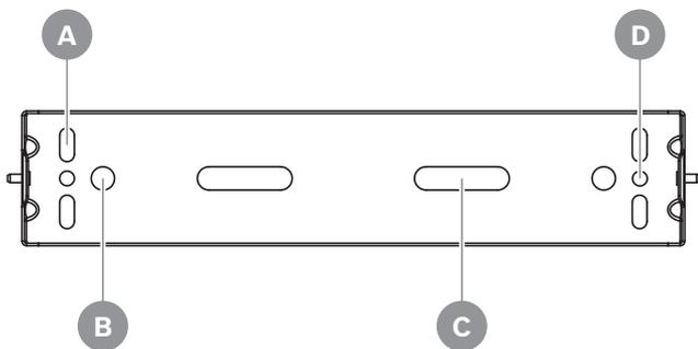
**A** Para montagem vertical ou horizontal usando quatro parafusos OU montagem em haste/treliça para um tamanho nominal do tubo de até 2" (DN50) usando dois parafusos em U. Aceita diâmetros de fixação de até 3/8 pol. ou M10.
