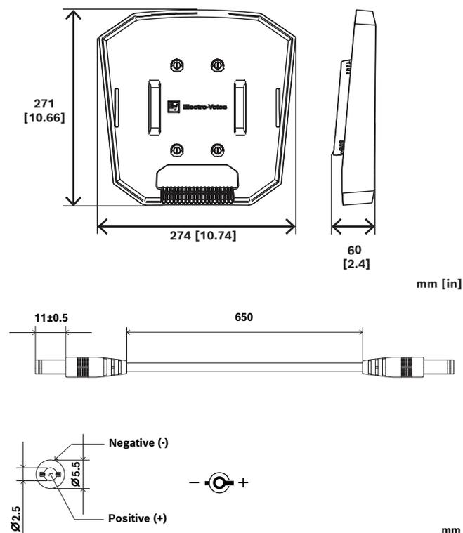
Fig. 1: Medições e polaridade do cabo de alimentação CC do EVERSE8
